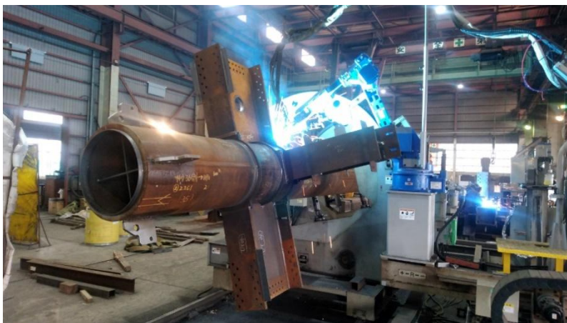
【柱溶接ロボット】
